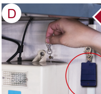
D Trong trường hợp khẩn cấp hoặc mất điện, có thể thao tác bằng tay hoặc dùng remote chuyển về "mở" để mở cửa cuốn tốc độ cao.
